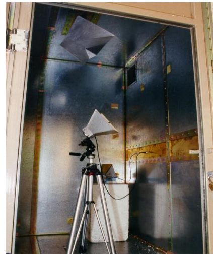
Figure 12 : Exemples de montages d'essai en chambre anéchoïque (1) et cage de faraday (2)
