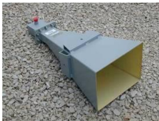
Figure 11 : Exemples d'antennes d'illumination hautes fréquences : log-périodique (1), cornet (2)
